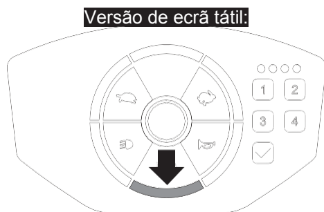
Figura 27 Normal: luz fixa Anormal: luz intermitente
